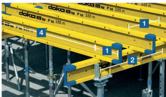
1-2-4: essas são as distâncias máximas para a montagem do Dokaflex. As marcas triangulares nas vigas funcionam como uma fita métrica integrada para lajes de até 30 cm de espessura.
